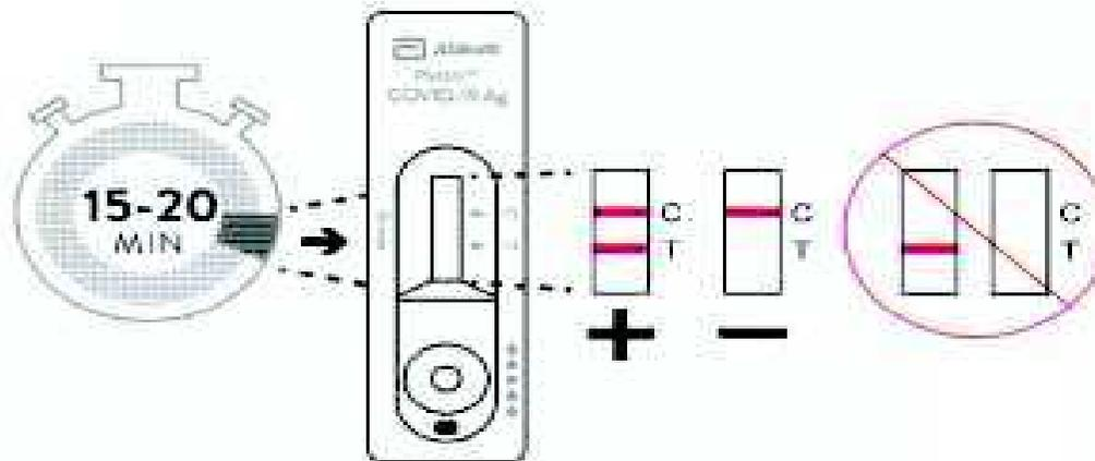
**POSITIVO** - Due bande: una banda T e una banda di controllo C nella finestra dei risultati
